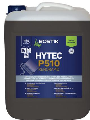
Als Grundierung zum Porenverschluss bei der Flächen-sanierung von Alt- und Betonuntergründen im Dachbereich vor der Abdichtung mit Aqua Blocker oder Aqua Blocker liquid anwendbar. Die Durchhärtung des letzten Auftrags von HYTEC P510 RENORAPID von ca. 2 Stunden muss vor der Weiterverarbeitung eingehalten werden.
